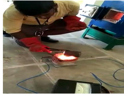
Fig-3. Metal pouring to mould
